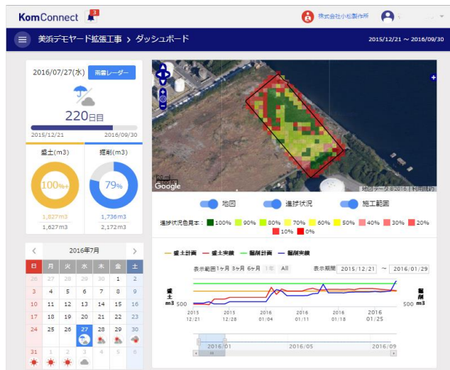
KomConnect ダッシュボード画面 (施工状況を一元管理できる画面)
