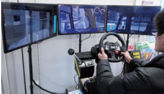
写真-5 除雪作業のシミュレータ
