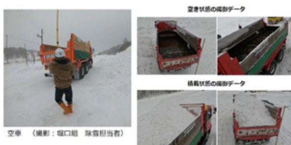
図-14 積載量の測定作業
