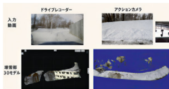
図-10 3次元点群化と積雪量算定の自動化
