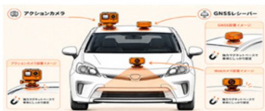
図-6 市販のWEBカメラとGNSSを取り付けた測定車両
