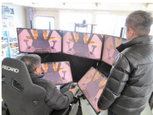
写真－5 除雪グレーダのシミュレータ （東北地方整備局東北技術事務所）
