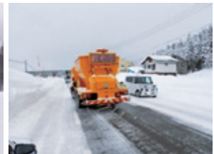
凍結防止剤散布状況
