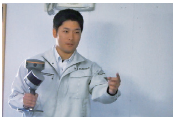
写真-4 高精度ハンディ型3Dレーザースキャナー
