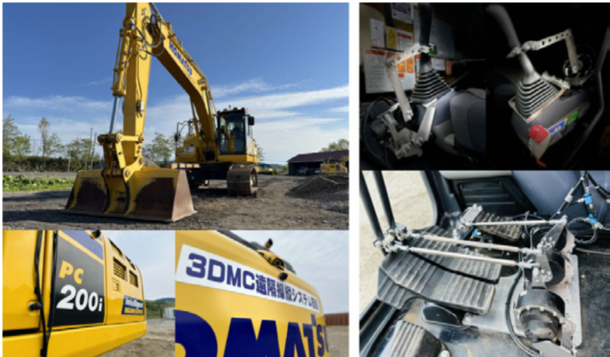
写真－1 3DMCバックホウの外観と運転席内部の遠隔操縦システム搭載状況
