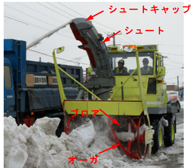
写真－1 ロータリ除雪装置（ロータリ除雪車）
