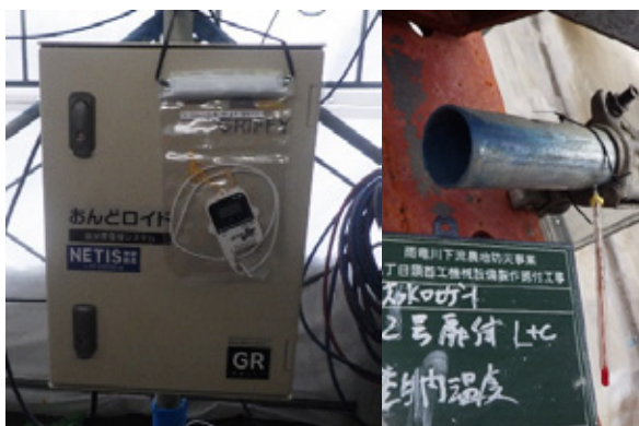
写真-21 デジタル温度測定器（おんどロイド）及び棒状温度計
