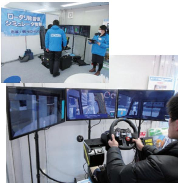
写真-5 除雪作業のシミュレータ
