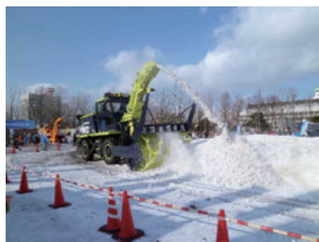
i-Snowロータリー除雪車の実演状況
