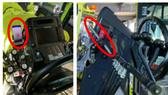
写真－4 スマホ設置状況 （左側：正面から、右側：側面から）
