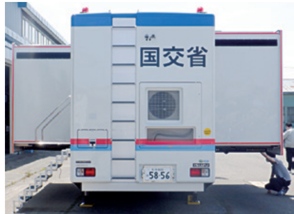
写真5 両側片持ち張出し状況
