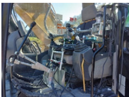
写真-2-1 簡易遠隔操縦装置(ロボQs)装着状態
