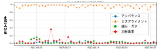
図－8 ポンプ主軸異常種別判定結果
