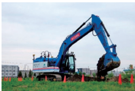
写真-1 分解組立型バックホウ全景
