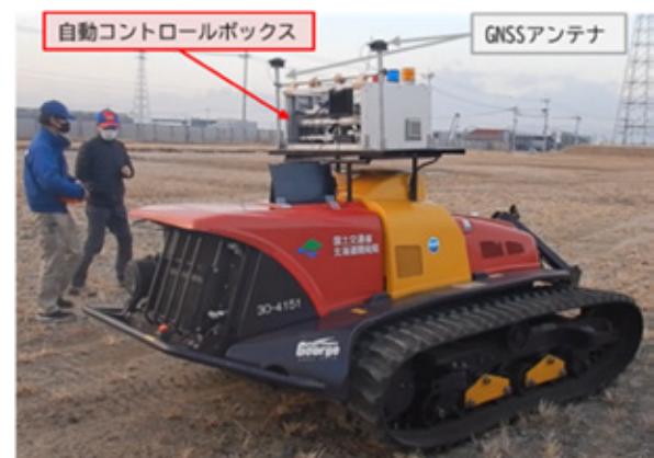
写真9 自動コントロールボックス取付状況
