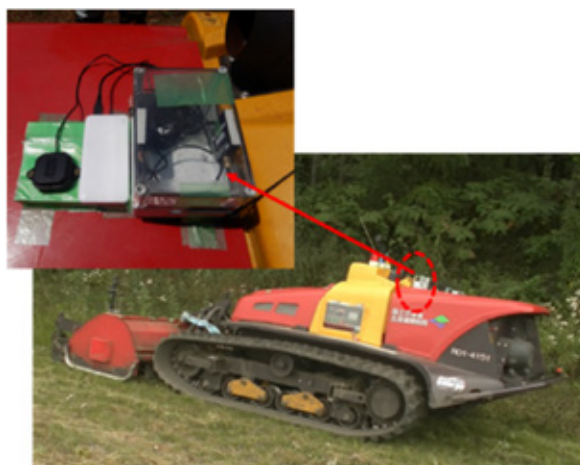
写真6 GNSS受信機設置状況
