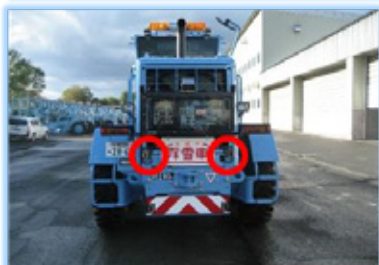
後方障害物注意喚起装置（ソナー式）
