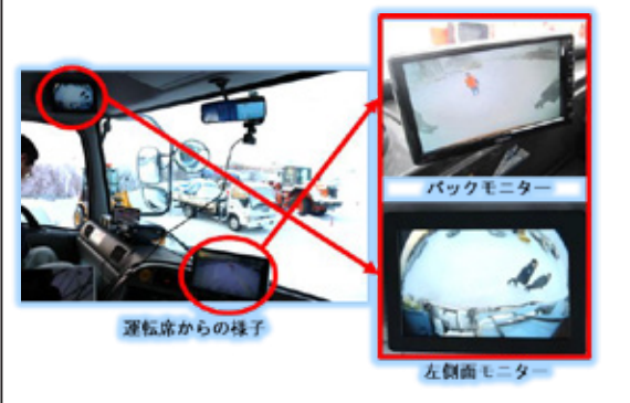
図2-3 バックモニター及び左側面モニター
