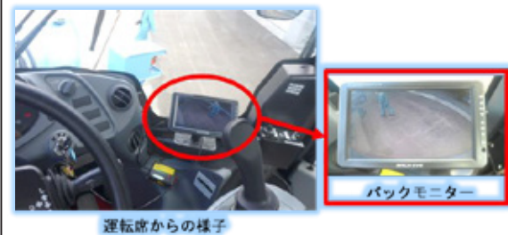
図2-2 バックモニター
