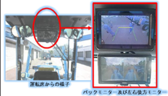
図2-2 バックモニター
