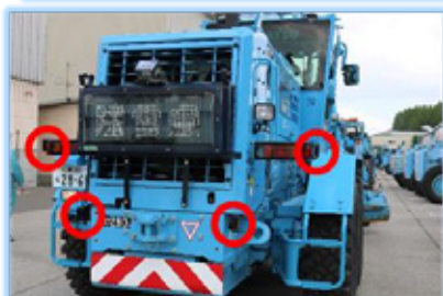
後方障害物注意喚起装置（赤外線式）
