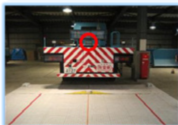
後方障害物注意喚起装置 (人とモノを見分ける喚起装置)
