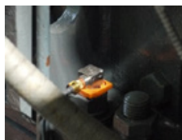
写真-2 エンジン据付部加速度計
