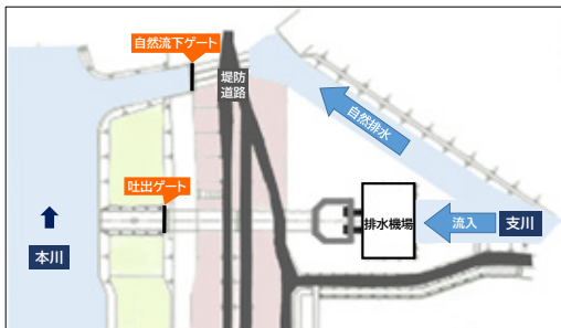
図－１ 排水機場ポンプ設備施設全体図
