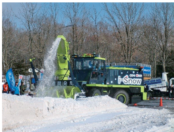
写真-3 実演状況 (開発局i-Snow仕様ロータリ除雪車)
