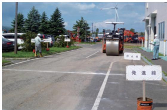
第4種（締め固め建設機械）試験状況
