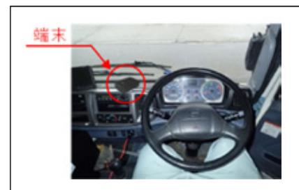
図3. GPS機器設置イメージ
