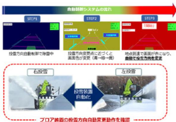
図-9 ブロー装置の投雪方向自動制御
