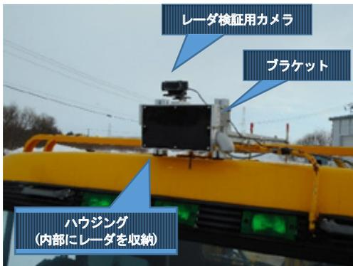
写真-6 ミリ波レーダ設置状況
