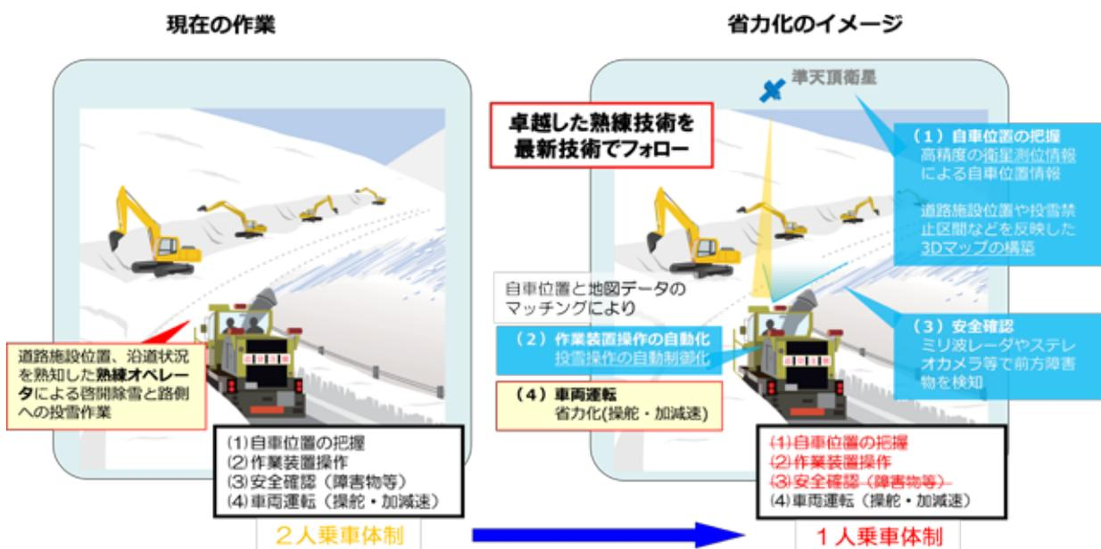
図-5 除雪作業の効率化・省力化イメージ
