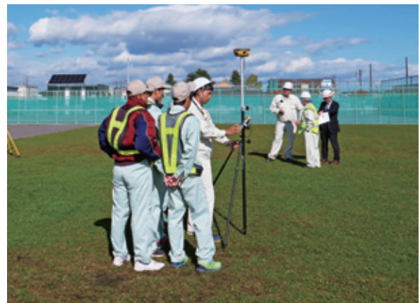
写真－５ GNSSローバーによる測量実習 （帯広工高・ユナイト㈱担当）
