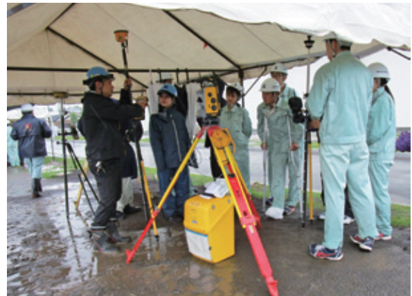
写真－４ 自動追尾型TSによる測量実習 （札幌工高・㈱カナモト担当）
