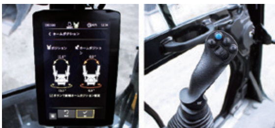
写真－６ モニター及び操作レバー
