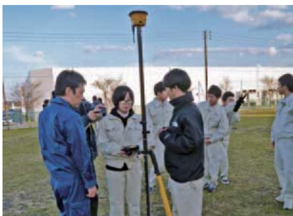
写真-4 GNSSローバーを利用した計測実習
