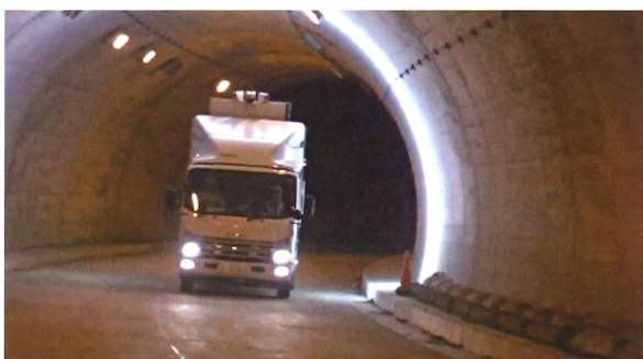
写真-11 トンネル点検ロボット
