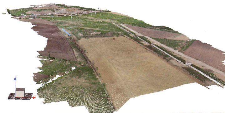
図4 UAV測量による点群データ
