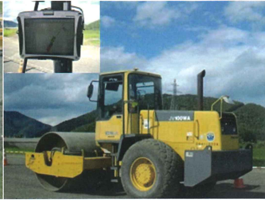
GNSS締め固め管理技術
